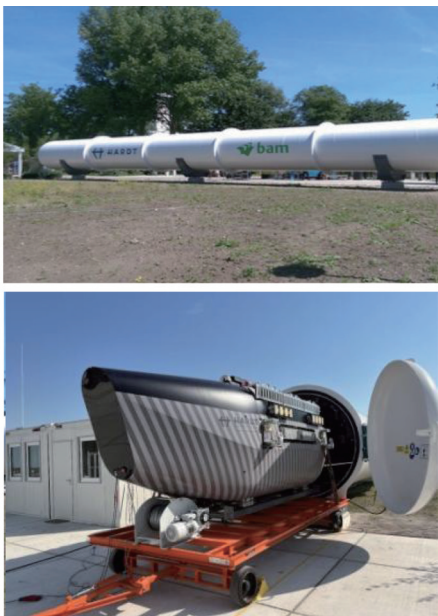
图3 Hardt Hyperloop运输系统中的30 m测试管道和试验车 [14]
