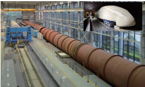
图7 时速400公里级高速动模试验台 [23]
