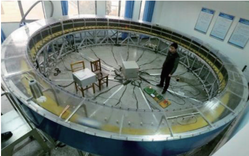
图6 侧挂悬浮型高温超导磁浮环线轨道系统 [22]
