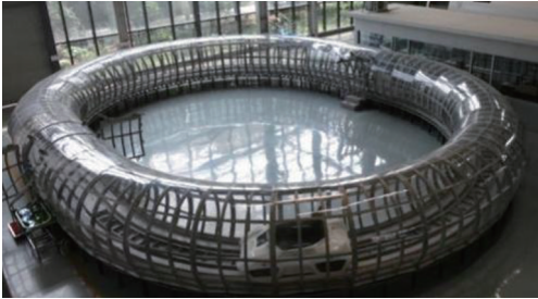
图5 西南交通大学低真空管道磁浮环形试验线 [21]
