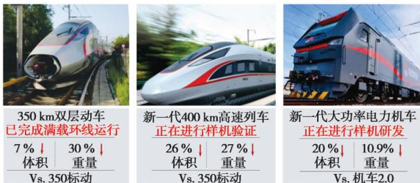
图23 应用PCU的双层动车、新一代动车和机车
