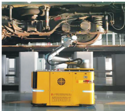
图3 列检机器人本体
