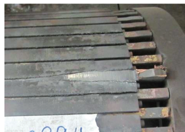
(b) 断裂、上翘、过热的转子导条示意图
