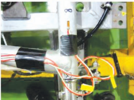
图 22 原型上框架测试点布置
