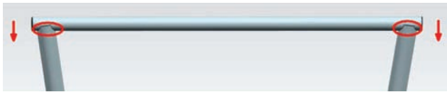
图 11 焊后顶管焊接变形
