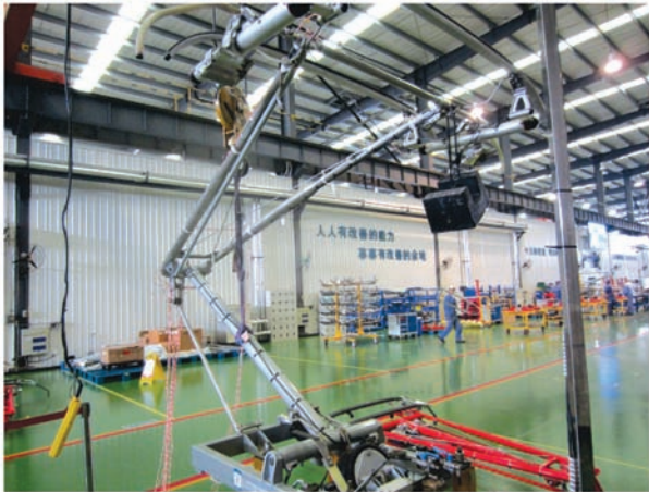
图 24 上框架顶管加载垂向 500 N 负载
