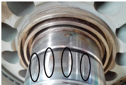
图1 轴承内圈滚道凹痕
