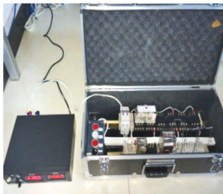
图3 测试继电器线圈动作正常无卡滞
