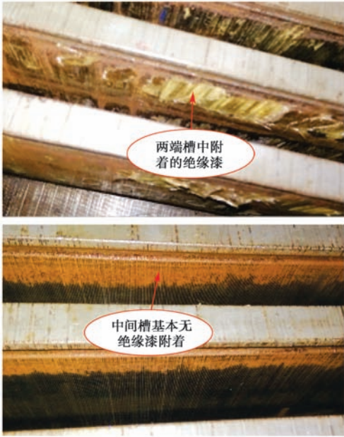
图 5 拆解电机绝缘漆分布示意图
