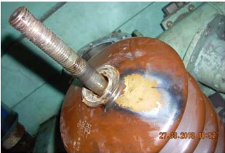
图 1 13008A 号牵引变压器 A 瓷瓶第 1 个裙边放电
