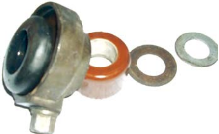
图 2 厚算盘珠状垫错误安装在压盖上
