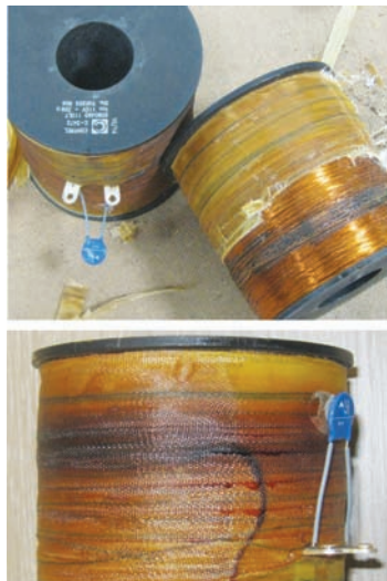
图 4 线圈烧损情况
