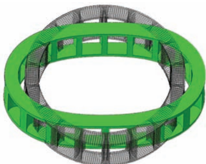
图 1 保持架径向椭圆变形示意图
