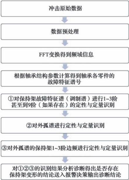
图 10 保持架变形故障诊断模式识别流程图
