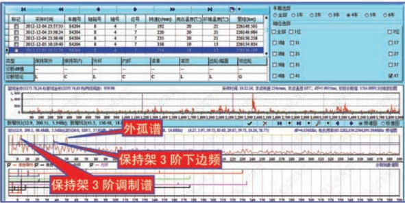
图 9 地铁车辆轴箱轴承原始数据的时域频域分析图
