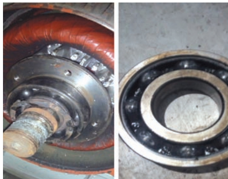
图 1 牵引风机电机轴承磨损图
