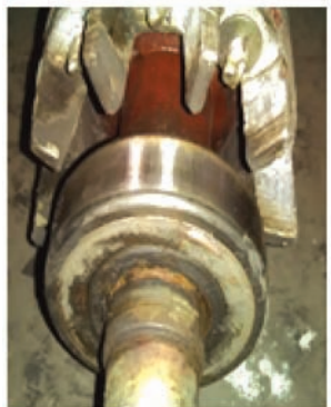
图 2 牵引风机电机被锈蚀
