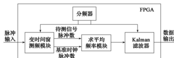
图 1 速度信号采集和处理的 FPGA 实现内部框图
