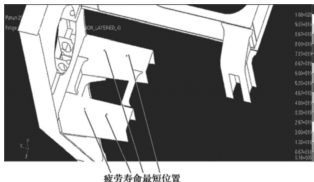
图7 构架疲劳寿命最短的位置
