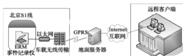
图2 基于GPRS的数据传输链路示意图
