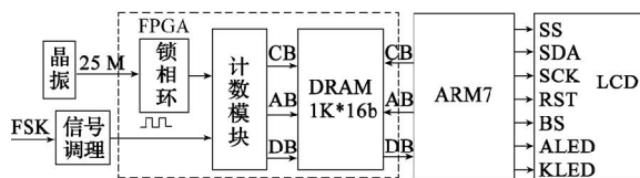
图 2 FSK 信号测量原理图
