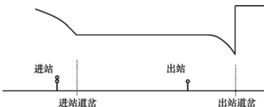
图2 进岔限速高于出岔限速的控制曲线
