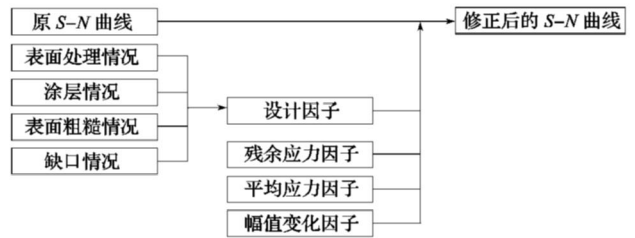
图 3 非焊接件修正 S-N 曲线过程
