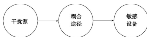
图 1 电磁干扰三要素及其关系模型
