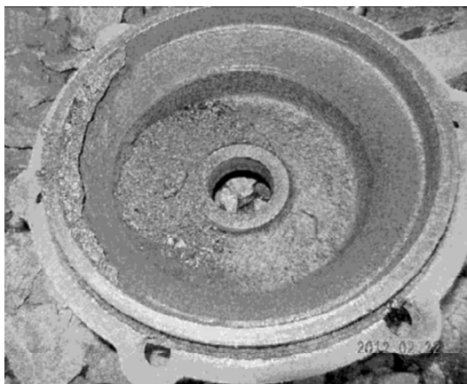
图1 故障后二位轴左侧轴箱端盖内油脂碳化物状况
