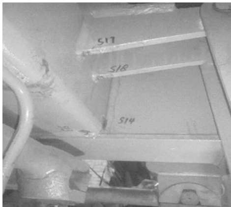
图4 动应力试验测点处应变片贴法
