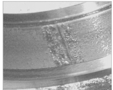
图 1 SS 6B 1018 轴箱轴承剥离图片
