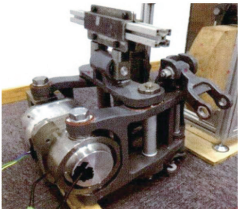
图26 电机械盘形制动单元
